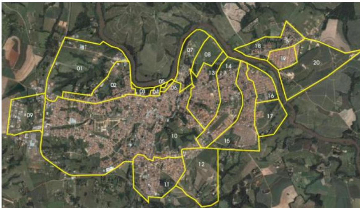
Figura 135 - Bacias e sub-bacias de esgotamento sanitário.
