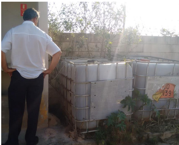
Figura 205 - Armazenagem de nitrato de amônia.
