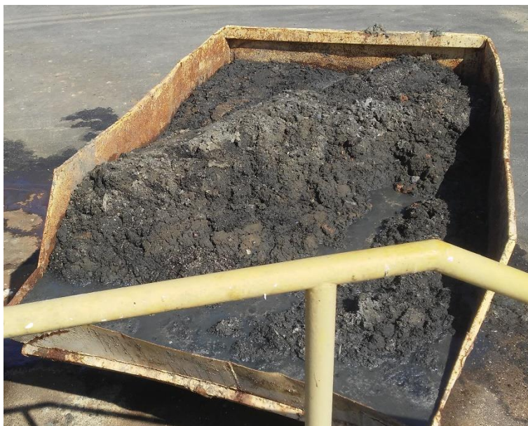
Figura 218 - Areia retirada do desarenador.
